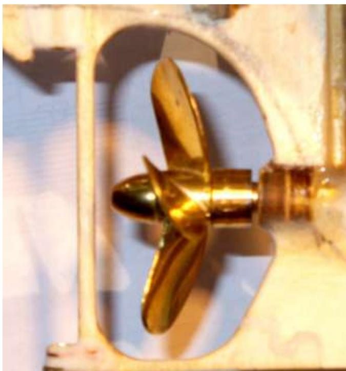
Lt. Baukasten war zwischen Rumpf und Propeller nur eine kleine Mutter. Ich finde, dass die Variante mit einem Messingrohr um die Mutter gelötet besser aussieht.
