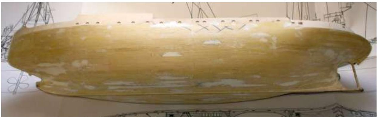
Bei den „Kreuzen“ ist der Rumpf durch das Schleifen und Spachteln schon etwas dünn.
