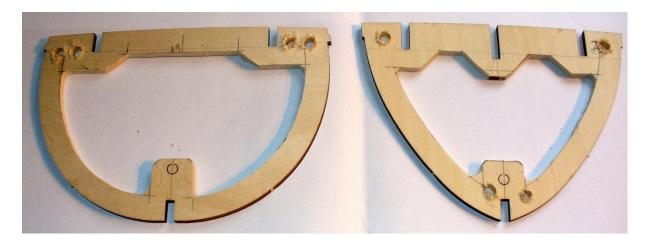
Mittlerweile sind alle Spanten "erleichtert". Ich verspreche mir davon mehr Platz im Rumpf, etwas weniger Gewicht was mir vermutlich beim späteren Überlaminieren zugutekommt. Stabilität büße ich durch das Erleichtern nicht ein.
