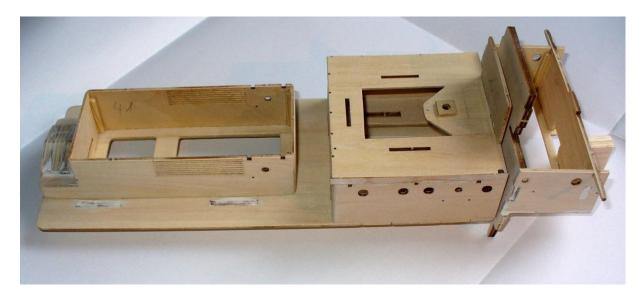
In den Sperrholzteilen der Aufbauten wurde alles herausgeschnitten was später nicht zu sehen ist. In die Ecken der zusammenzuleimenden Teile habe ich immer schön 3x3-Leisten hinterlegt um die Stabilität zu erhöhen. Rechts auf dem Bild ist das eigentlich It. Anleitung fest auf dem Rumpf angebrachte Brückenhaus zu sehen.
