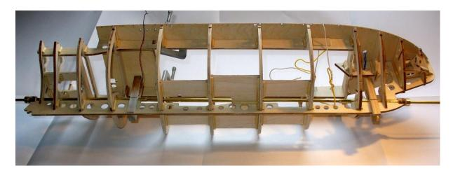
Auf dem Foto ist das durchgeschobene MS-Rohr deutlich zu erkennen.
