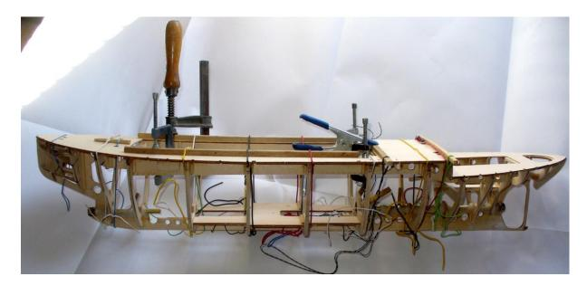
Und zwar war es gar nicht so einfach das Vordeck in seiner Form an die Spanten anzudrücken. Das Harz hatte eine Topfzeit von 40 min was mir hierbei sehr entgegen kam. Das Deck wurde mit diversen gespannten Drähten, Klammern und Zwingen angepresst. Die Verklebungen wurden wiederum mit eingelegten 3x3mm Holzleisten verstärkt. Auf diesem Bild ist das Achterdeck und die Stufe zum Vordeck bereits fertig montiert.
